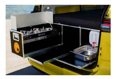
Auf der Rückseite der BusBox-4 befinden sich sogenannte Lüftungsschlitze, durch die bei Platzierung einer Kühlbox im mittleren Fach der Stromzufuhr gelegt werden kann. Des weiteren wird dadurch die Luftzirkulation für die Kühlbox sichergestellt.
